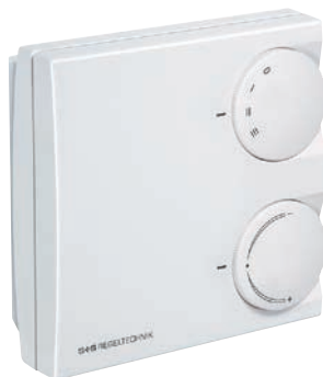
Modèle avec sonde, potentiomètre (1 kOhm, max. 0,1 W) et commutateur rotatif (max. 24 V ca/cc, max. 130 mA)
